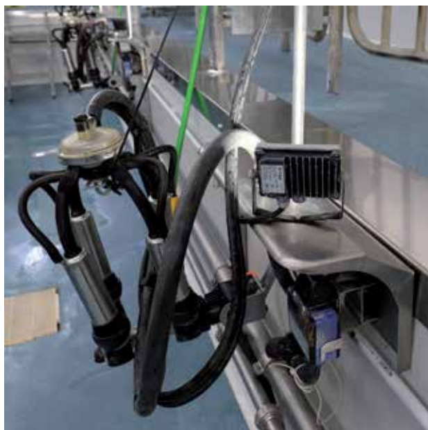
PER LAVORARE MEGLIO DURANTE LA MUNGITURA SONO STATI INSTALLATI DEI FARETTI LED PER ILLUMINARE LA MAMMELLA DELLE BUFALÉ
